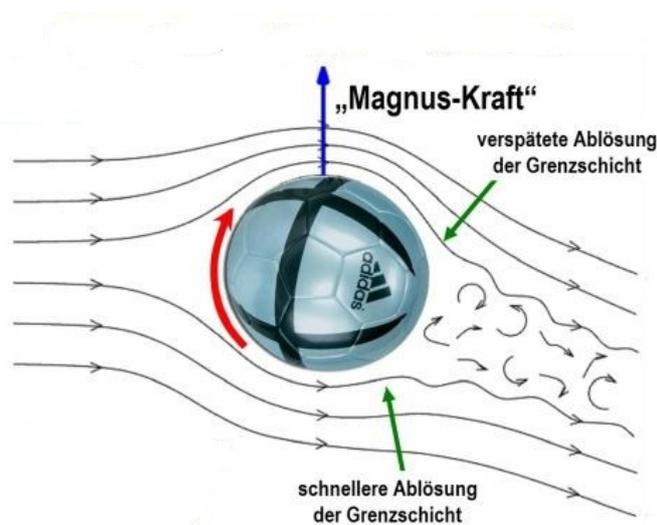
Abb. 4.12: Erklärung des Magnus-Effekts mit der asymmetrischen Ablösung der Grenzschicht [Tol10a, S.214], [10]
