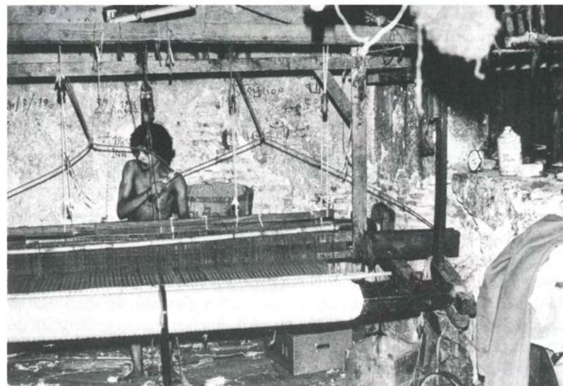
Bild 3. Der abgebildete Webstuhl wurde erst vor einigen Wochen auf Kaytechnik umgestellt. Das Seil, mit dem das Weberschiffchen durch das Fach gepeitscht wird, ist am Gerüst des Webblattes befestigt, desgleichen die Fangkästen für das Schiffchen. Da der Raum – im vorliegenden Fall – zu klein war, wurde kurzerhand das Mauerwerk ausgehöhlt.
