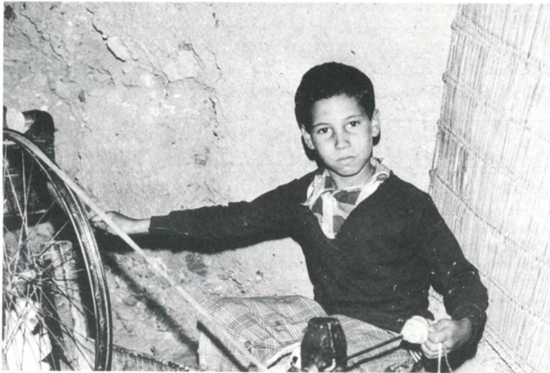
Bild 1. Das Bild zeigt einen 7-jährigen Jungen, der Schußgarn auf Bambusstäbchen spult. Gut zu erkennen ist das Metallrad (Fahrradteil), das das traditionelle Holzrad in fast allen Betrieben Marokkos ersetzt hat.
