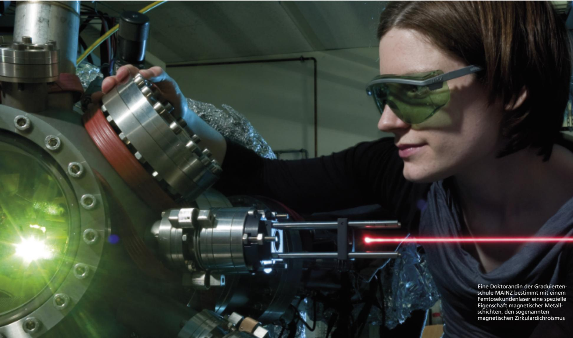
Eine Doktorandin der Graduiertenschule MAINZ bestimmt mit einem Femtosekundenlaser eine spezielle Eigenschaft magnetischer Metallschichten, den sogenannten magnetischen Zirkulardichroismus
