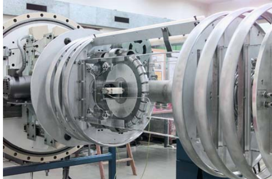
Abb. Der geöffnete Beschleuniger des AMS der ETH
