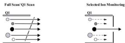
Abbildung 8: Schema für Full Scan und Selected Ion Monitoring
