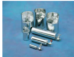
Abb. Standard-Probenahmebehälter aus Edelstahl (Summa-Kanister)
