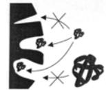
Abb. Prinzipien der SEC (oben) und Slalom-Chromatographie (unten)
