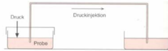
Abb. Prinzip der Druck-Injektion (Überdruck auf der Injektions- oder Unterdruck auf der Detektorseite)
