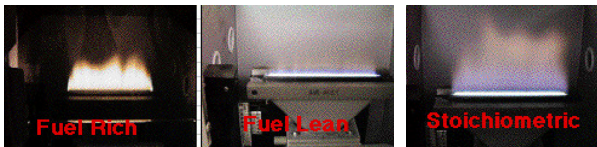
Abb. Brennstoffreiche (li), -arme (mi) und stöchiometrische Flamme (re)
