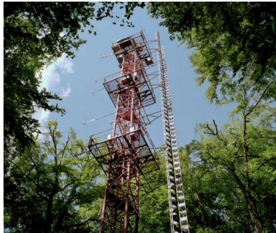
Um die Nettoemission an reaktiven biogenen flüchtigen organischen Verbindungen abschätzen zu können, wurden Freilandmessungen durchgeführt. Hier ein Blick auf den während des ECHO-Projektes eingesetzten Messturm im Stettener Forst in Jülich. Die Messungen erfolgten höhenauflöst vom Boden bis oberhalb des Kronenraums.
