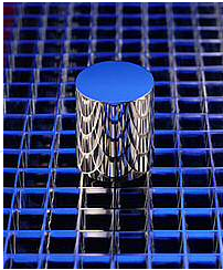
Das Urkilo: Zylinder von 39 mm Höhe und 39 mm Durchmesser, (Legierung 90 % Platin 10 % Iridium)
