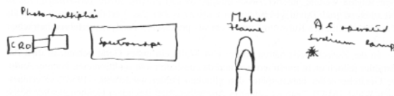
Abb. Erster Entwurf einer analytische genutzten Atomabsorption aus einem Bericht aus dem Jahre 1952.
