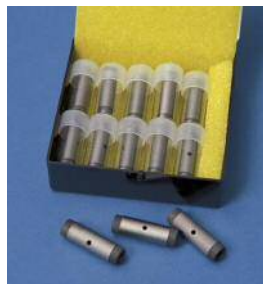
Abb. Graphitrohre für die ET AAS (auch GF AAS (Graphite Furnace AAS))
