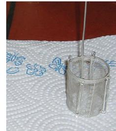
**Abb.** Platinelektrode zur Elektrogravimetrie
