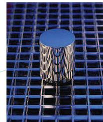
Das Urkilo: Zylinder von 39 mm Höhe und 39 mm Durchmesser, (Legierung 90 % Platin 10 % Iridium)
