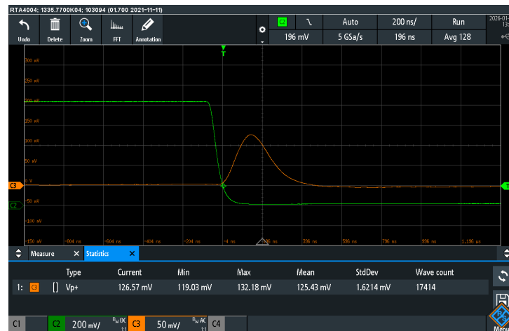
Abbildung 5.2.: Durch die Averaging -Funktion des Oszilloskops entsteht ein Signal mit unterdrücktem Rauschen (orangefarbene Kurve), das durch eine Injektion (grüne Kurve) ausgelöst wurde.
