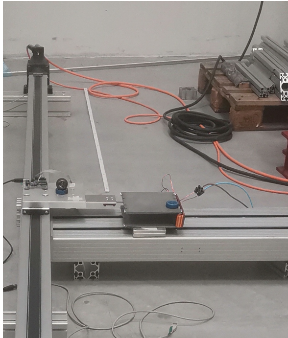
Abbildung 13: Im gezeigten Aufbau befindet sich ein Elektromagnet mit magnetischem Nest auf einer manuellen Schiene in einer älteren Konfiguration. Mit diesem Aufbau wackelte die manuelle Schiene, weshalb der Aufbau wie in Abbildung 12 geändert wurde. Die Schiene weist ein Magnetfeld im Bereich von -370 bis 640 \mu\text{T} auf. Aufgrund dieser Magnetisierung wurden die ursprünglichen Stützen entfernt, die Schiene direkt auf dem Boden positioniert und mithilfe am Boden haftender Halterungen fixiert. Anschließend wurde der Elektromagnet mithilfe von Stützen erhöht (siehe Appendix ??). Diese Maßnahme führte gleichzeitig zu einer Stabilisierung der Schiene, wodurch die zuvor beobachteten Positionssprünge – wie in Abbildung 19 dargestellt – nicht mehr auftraten.
