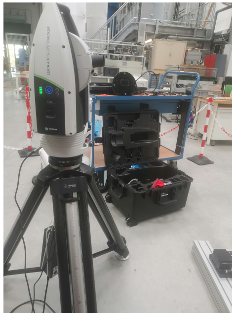
Abbildung 6: Laser-Tracker von der Seite mit Energie- und Verbindungsstatus. Der blaue Knopf bedeutet, dass der Laser-Tracker nicht mit einem Gerät verbunden ist und wird bei einer Verbindung grün. Dabei ist zu achten, dass sich während der Messung der Laser-Tracker und seine Stativ nicht bewegen.
