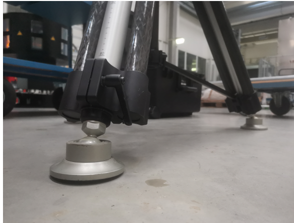
Abbildung 7: Ein Schlecht aufgestellter Stativ könnte möglicherweise den Laser-Tracker bewegen. Dies hätte zur Folge, dass die nächsten Daten mit einem anderem Koordinatensystem gemessen werden. Bei der Bestimmung der Winkel werden dementsprechend hohe Standardabweichungen auftreten.
