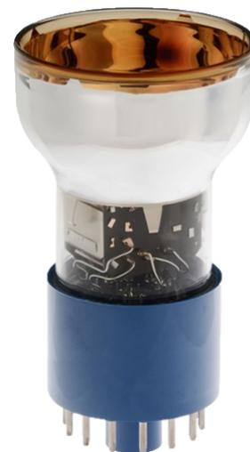
(b) ET9305 PMT, ähnlich der im P2-Experiment verwendeten PMTs aus [3]
