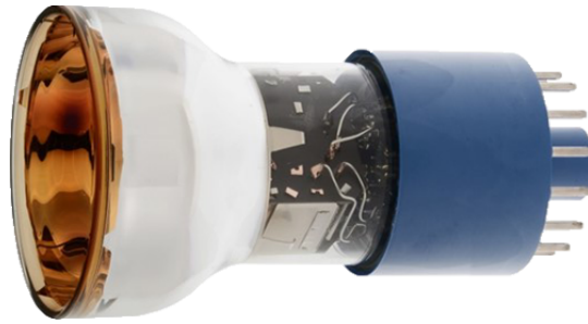
Abbildung 4.6: Bild eines Photomultipliers vom Typ 9305QKB von ET Enterprises. Entnommen aus [11].
