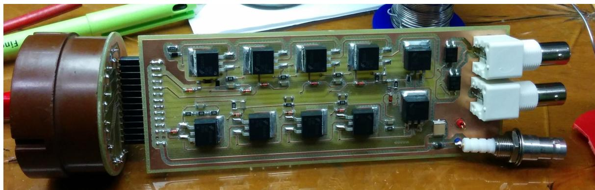
Abbildung 10: Foto des Gesamtaufbaus des Spannungsteiler-Prototyps
