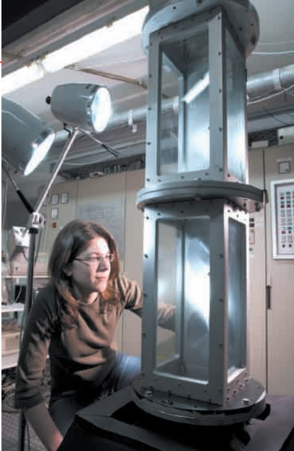
Eine Studentin am Mainzer Vertikalwindkanal: Untersuchung von Strömungseigen- schaften von Tropfen
