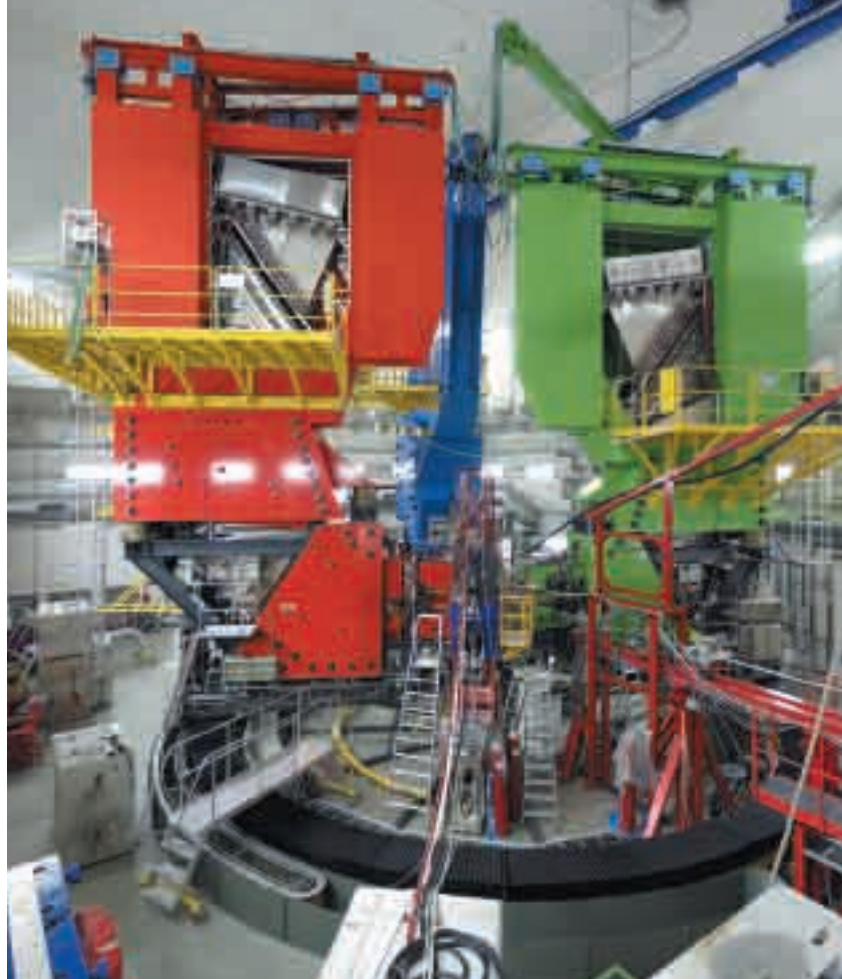
Drei-Spektrometer-Anlage am Mainzer Mikrotron: Jedes der drei magnetischen Spektrometer ist ca. 300 Tonnen schwer und bis zu 16 Meter hoch.
