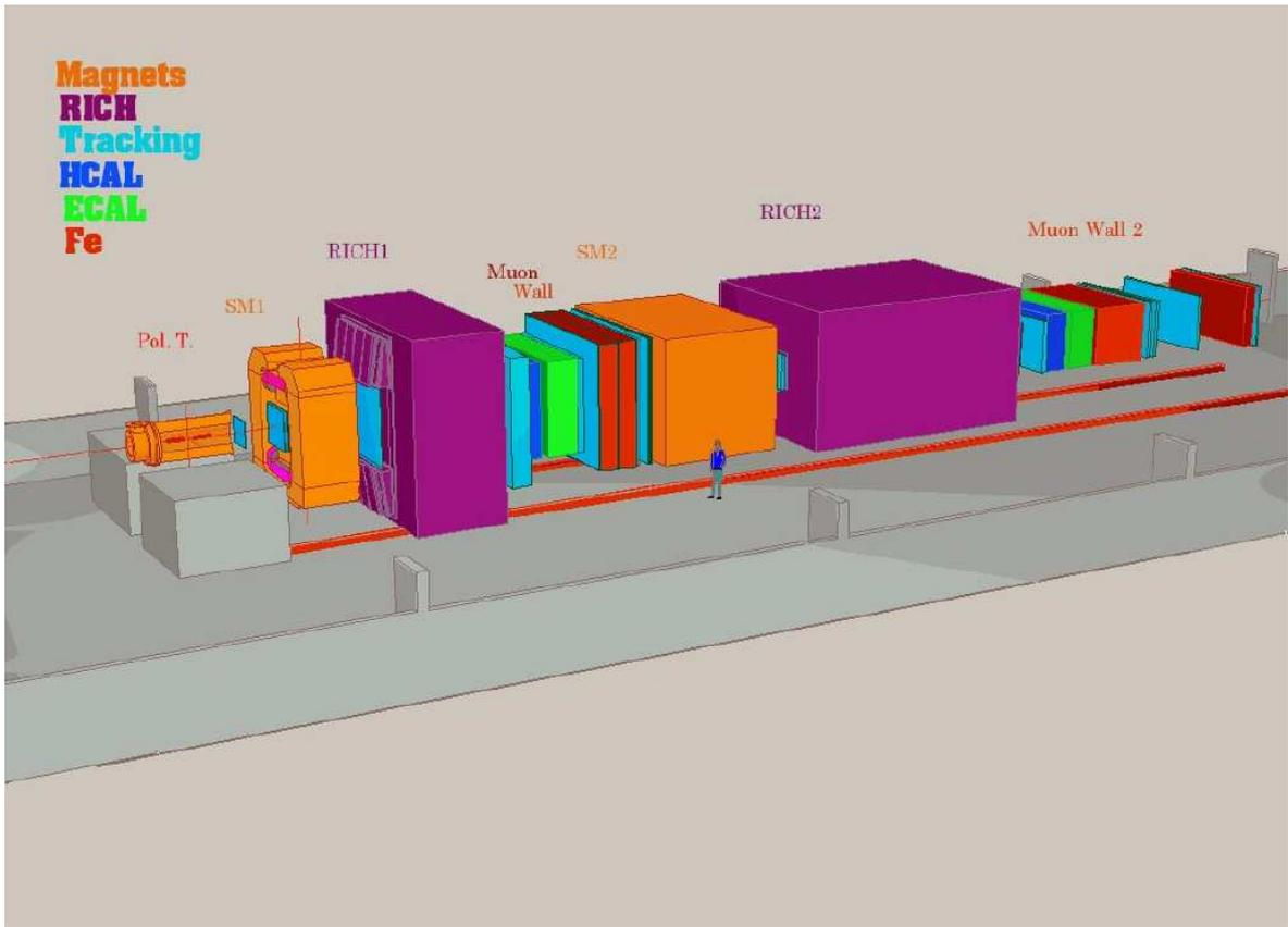
Abbildung 1: Schematische Darstellung des COMPASS-Experiments
