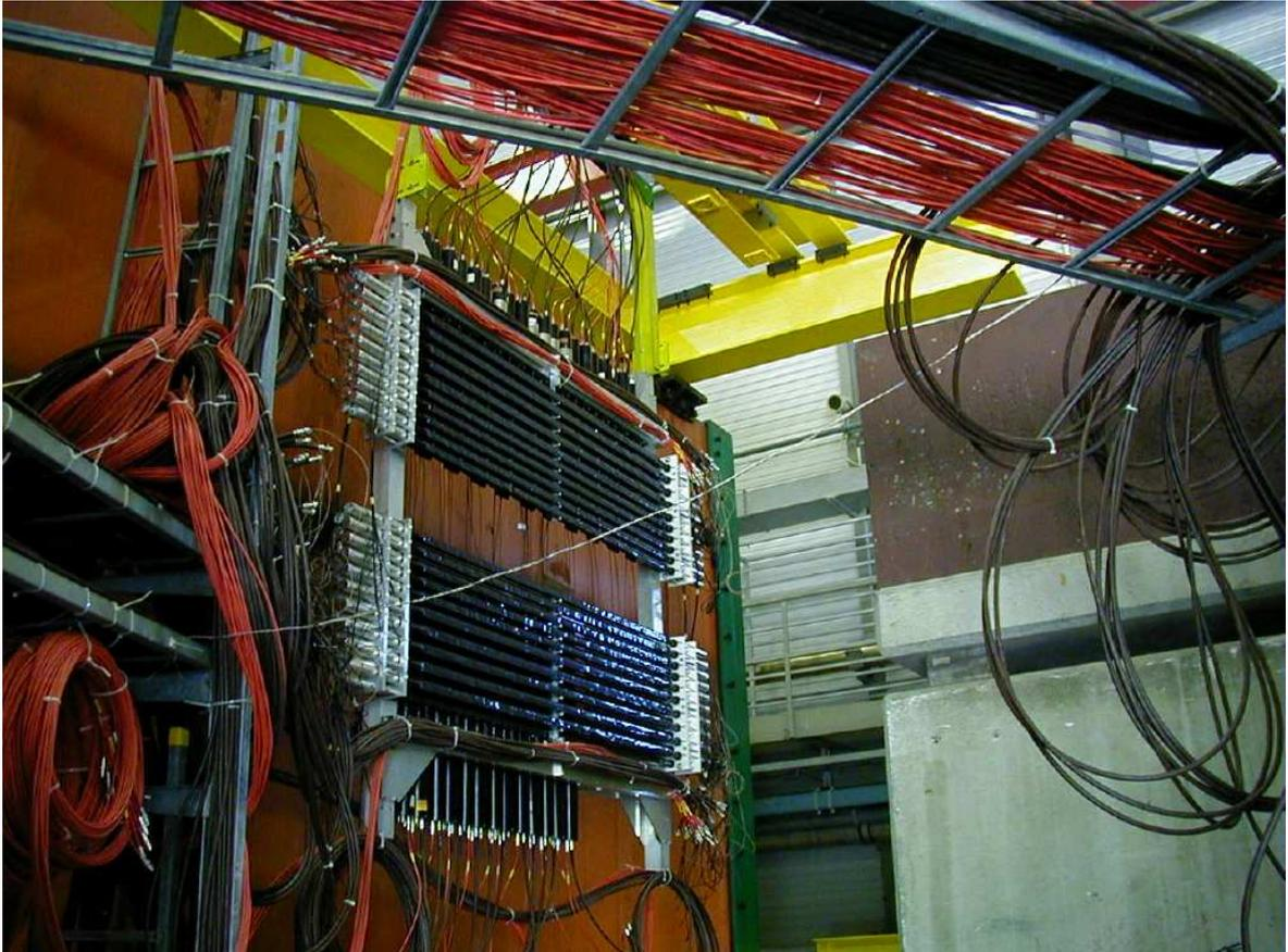
Abbildung 10: Triggerhodoscope
