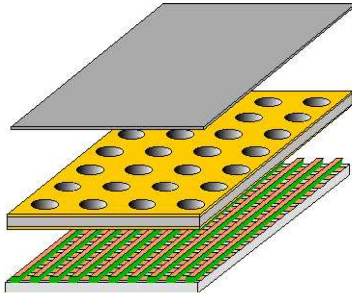
Abbildung 5: Prinzipieller Aufbau eines GEM-Detektors
