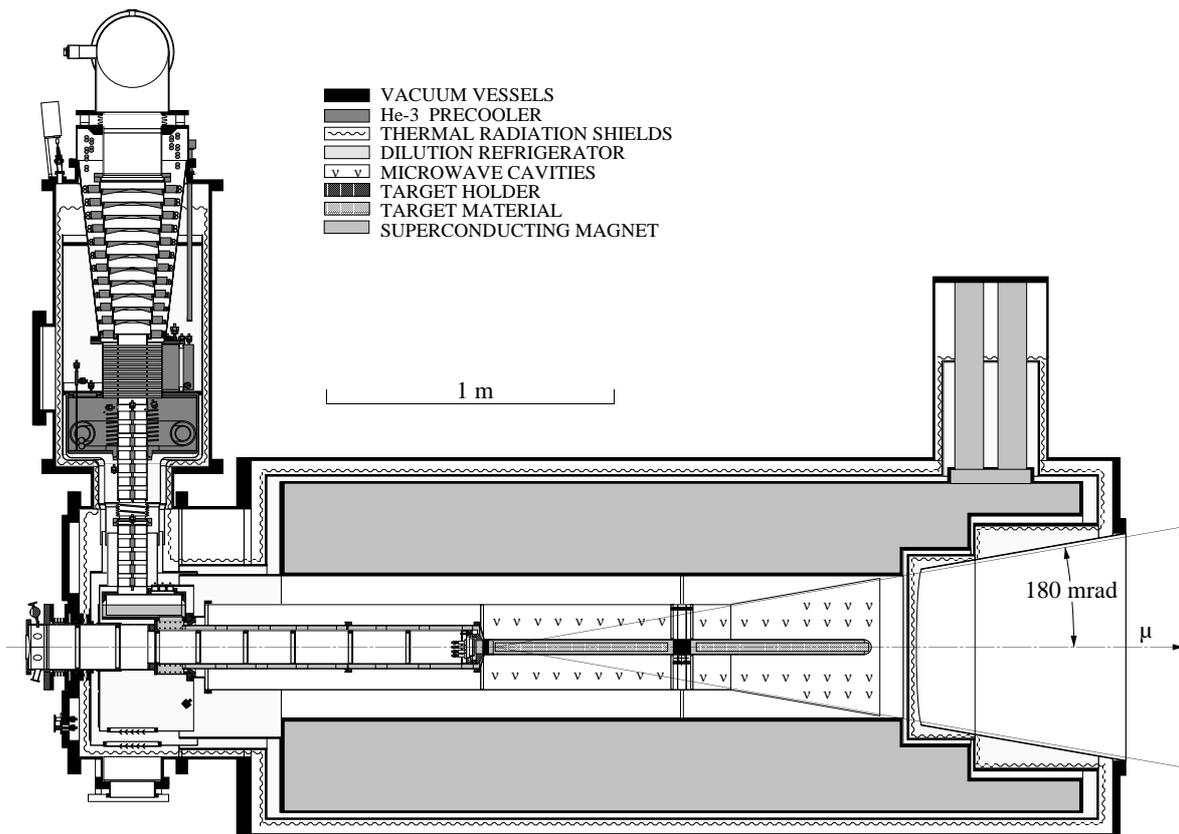
Abbildung 3: Schematische Darstellung des polarisierten Targets
