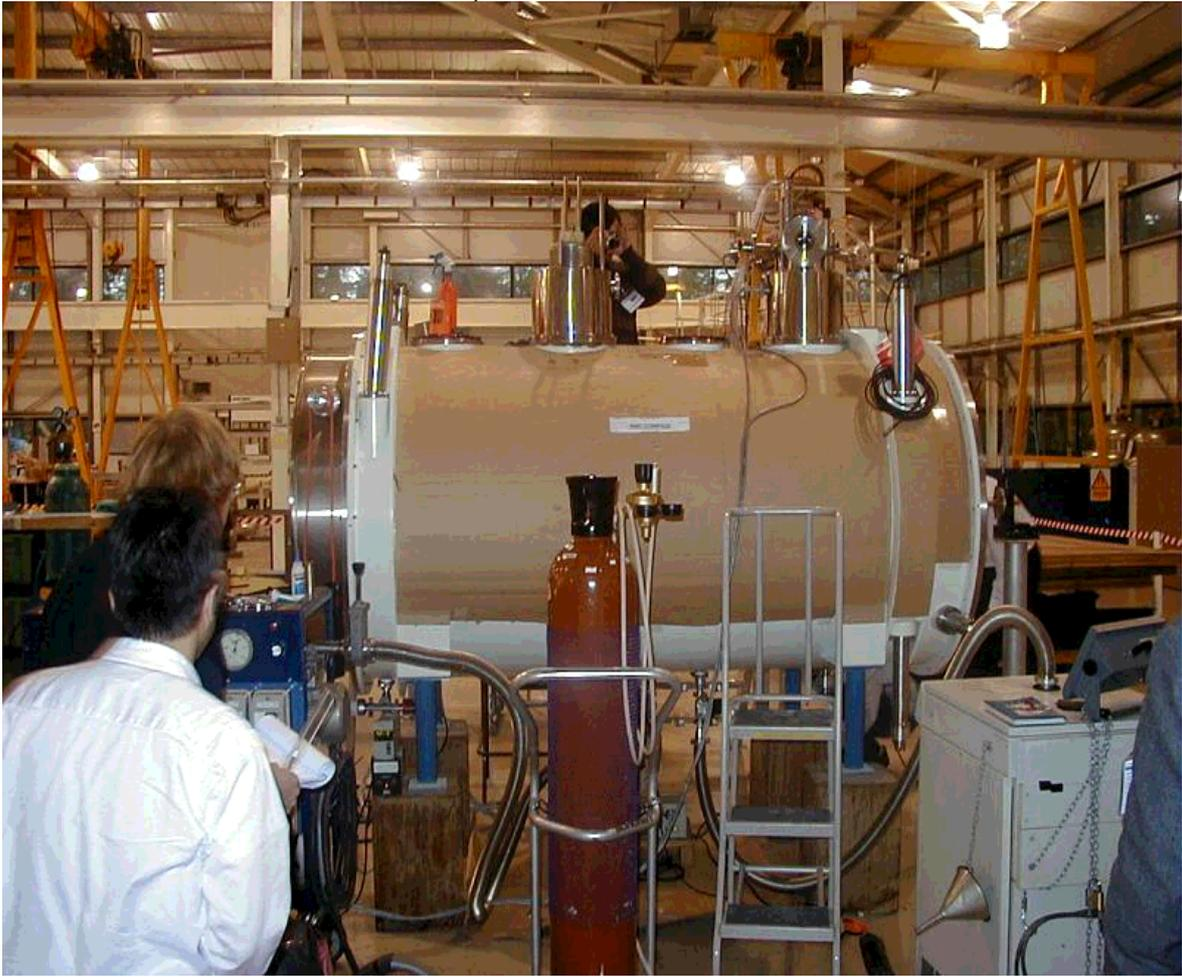
Abbildung 4: Der Kryostat mit supraleitendem Magneten in der Testphase
