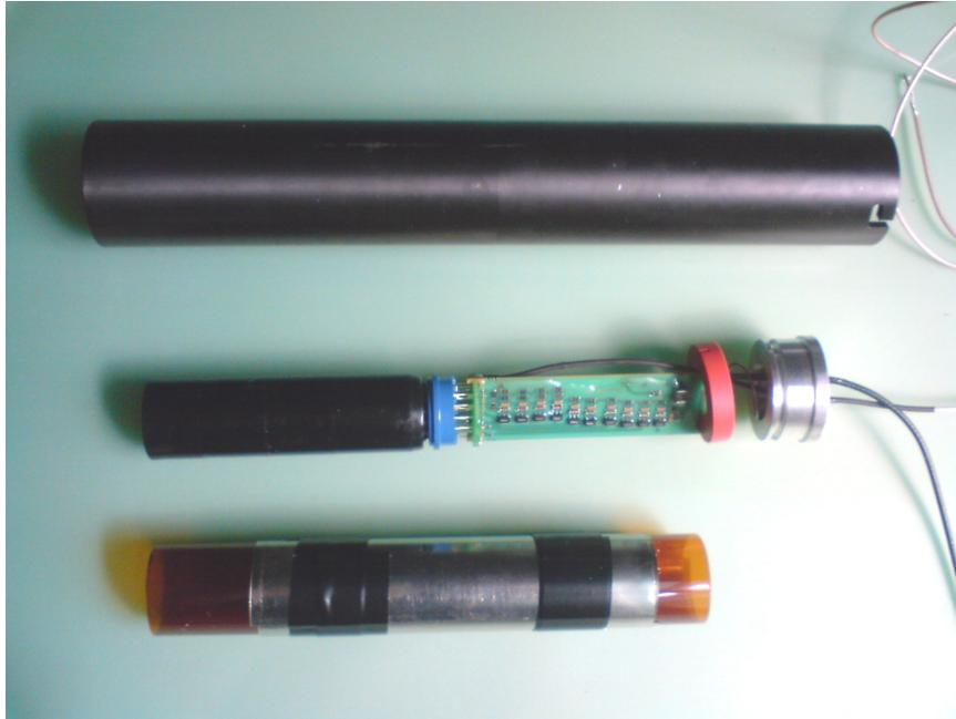
Abbildung 4.7: In H1 verwendete Komponenten zur Auslese der Lichtsignale: Weicheisenabschirmung (oben), Photomultiplier XP2900 mit Base und Endkappe (Mitte), Mumetallhülle mit brauner Kaptonfolie (unten)
