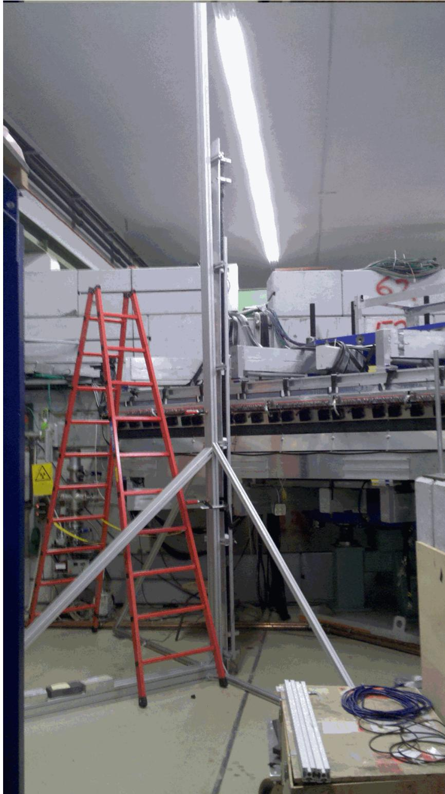
Abbildung 6.3: Blick auf den MAMI-Test-Messaufbau, an der vertikalen Schiene ist der Szintillatorschlitten befestigt, auf dem man in schwarz den Szintillator erkennen kann, im Hintergrund ist der Taggermagnet (blau) zu sehen. Der Schlitten befindet sich auf dem Bild in der tiefstmöglichen Position an der Schiene.
