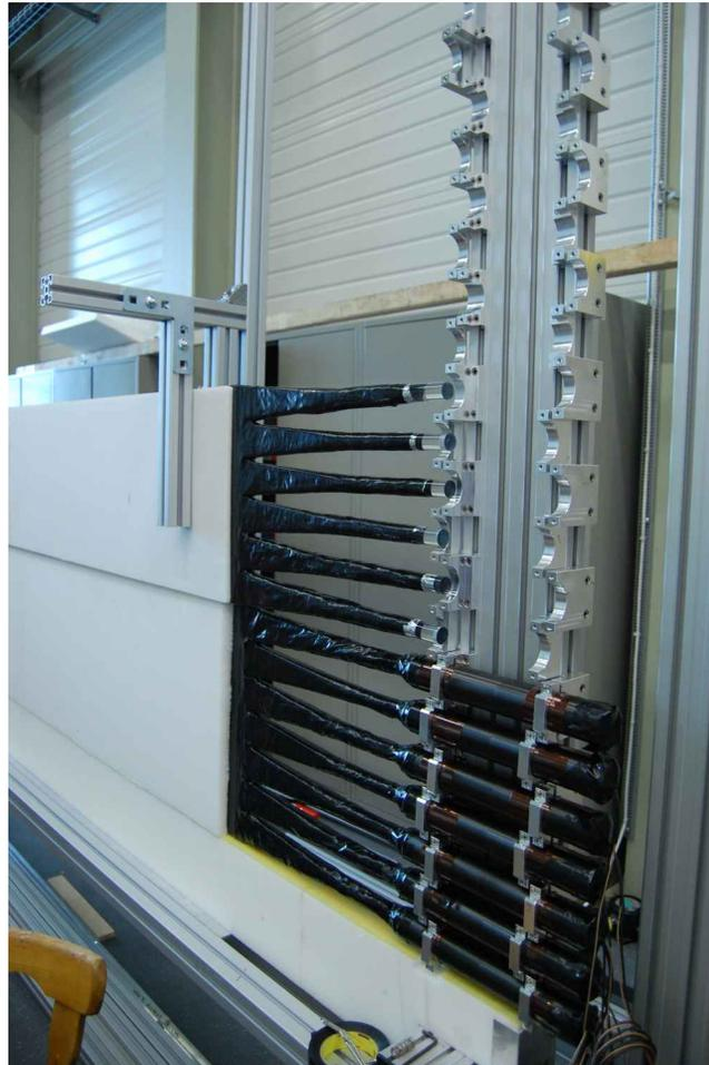
Abbildung 8.5: Installation der Szintillatorkomponenten auf dem Detektorrahmen, die untere Gruppe ist ausgerichtet, an der Vorderseite lichtdicht mit Tape-Band umwickelt und mit Kaptonfolie an der Halterung isoliert, die obere Gruppe wurde noch nicht lichtdicht gemacht
