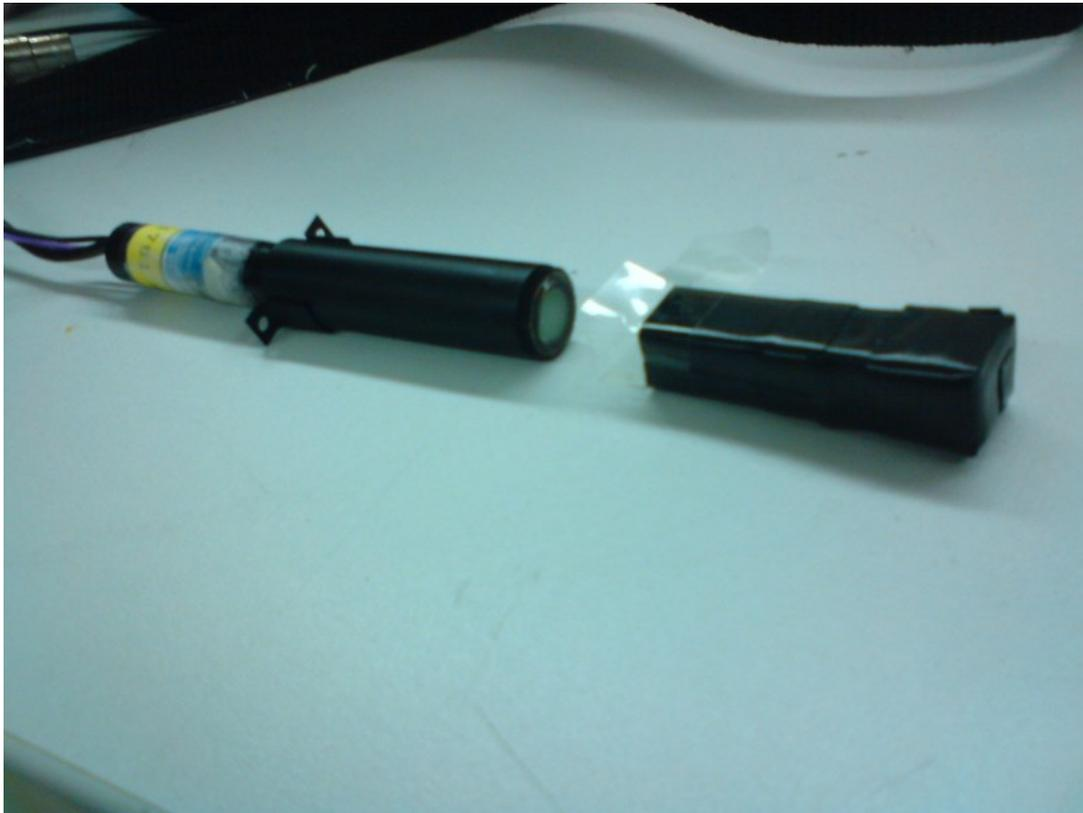
Abbildung 8.8: Pixelzähler als Triggerszintillator bei MAMI-Messung, der Photomultiplier wurde mit optischem Fett als Lichtkopplung direkt auf ein kleines Stück Szintillator gedrückt und mit Tapeband fixiert
