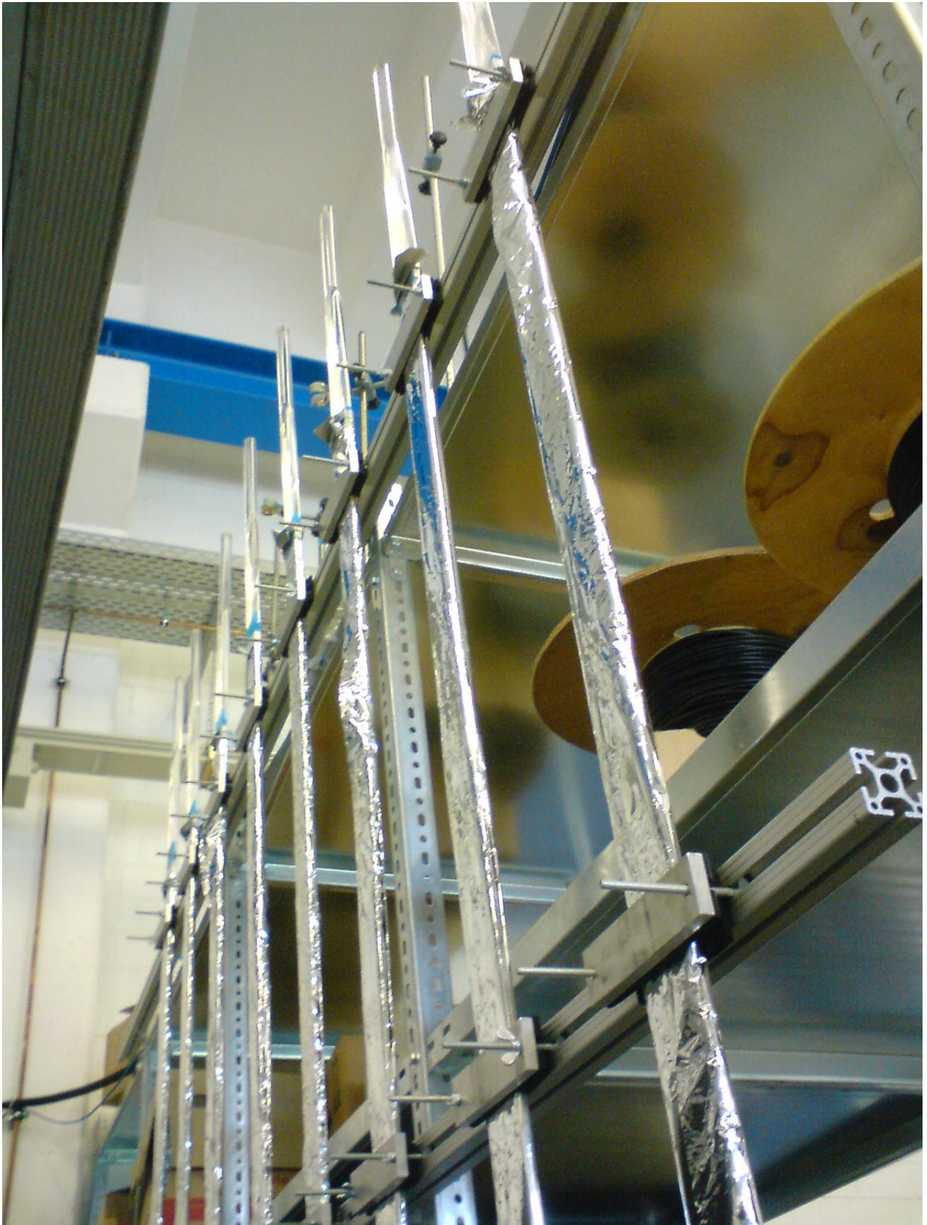
Abbildung 4.17: Kleben der Szintillatoren für H1
