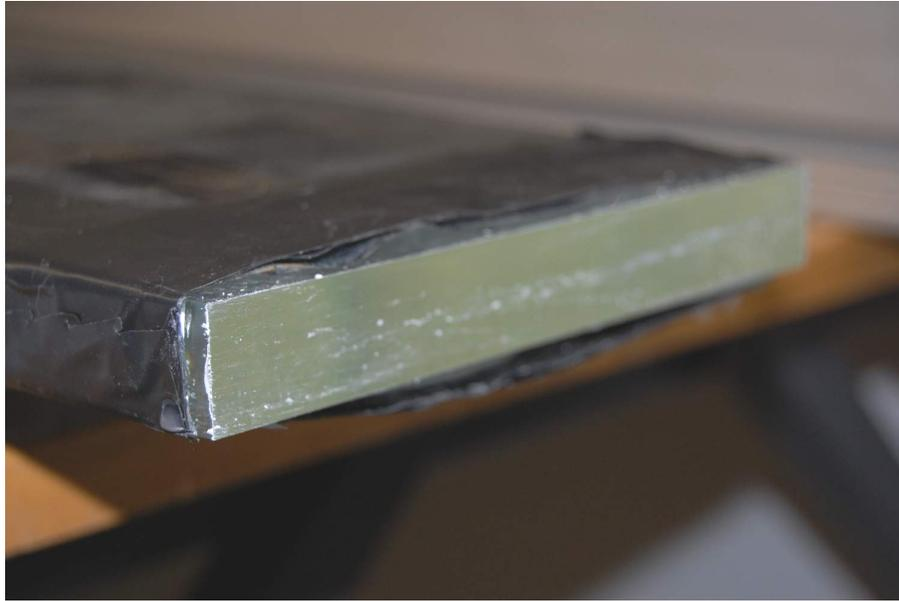
Abbildung 4.8: unpolierte Stirnfläche des Testszintillators
