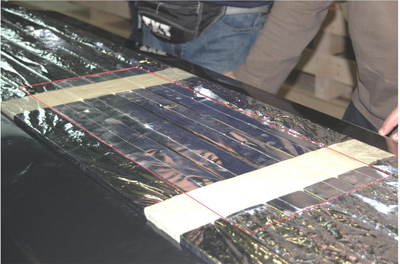
Abbildung 4.16: Die Luftlichtleiterpakete vor dem Umhüllen mit lichtdichter Folie (rot markiert zur Verdeutlichung)
