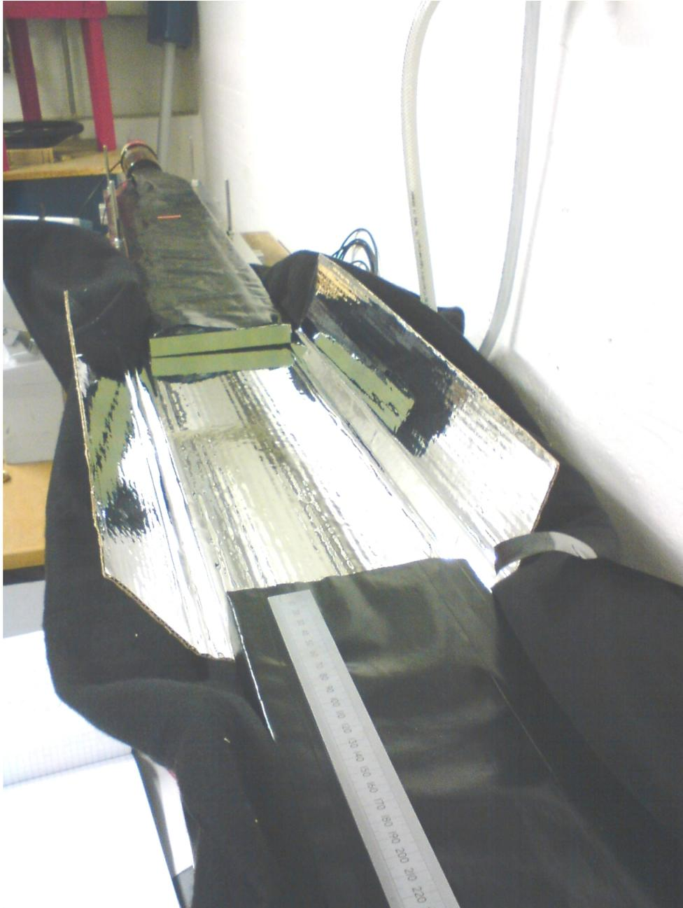
Abbildung 4.11: Luftlichtleiter aus Papphülle mit reflektiver Innenfolie (Mitte), im Vorder- und Hintergrund sind die Szintillatoren in schwarzer Folie verpackt
