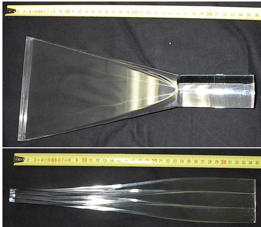
Abbildung 5.1: Beispiel eines Lichtleiters mit einer Fischschwanzgeometrie (oben) und eines gedrehten Lichtleiters (unten)
