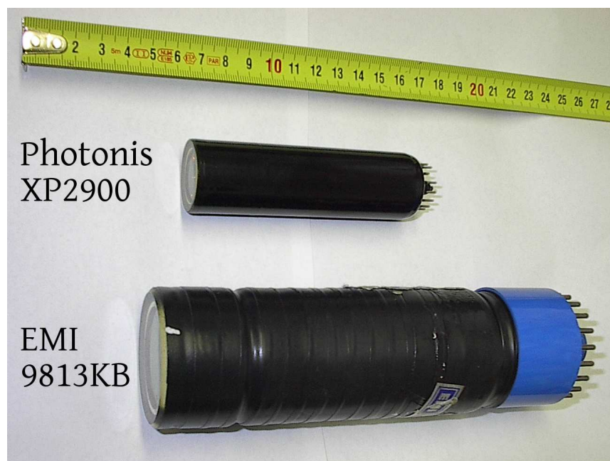
Abbildung 5.8: Bild der Photovervielfacher XP2900 und 9813KB.
