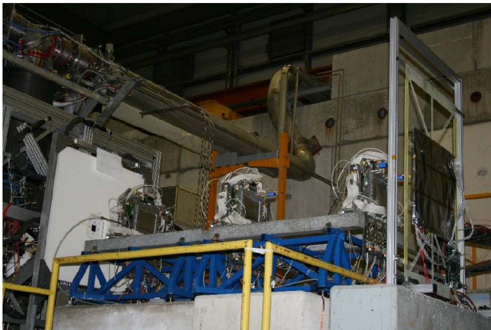
Abbildung 3.6: Testaufbau der Pixel-GEMs vor dem Target während der Myonstrahlzeit 2006. Von rechts nach links sind zuerst ein Pixel-GEM, dann drei Siliziumdetektoren und ein SciFi-Detektor zu sehen.
