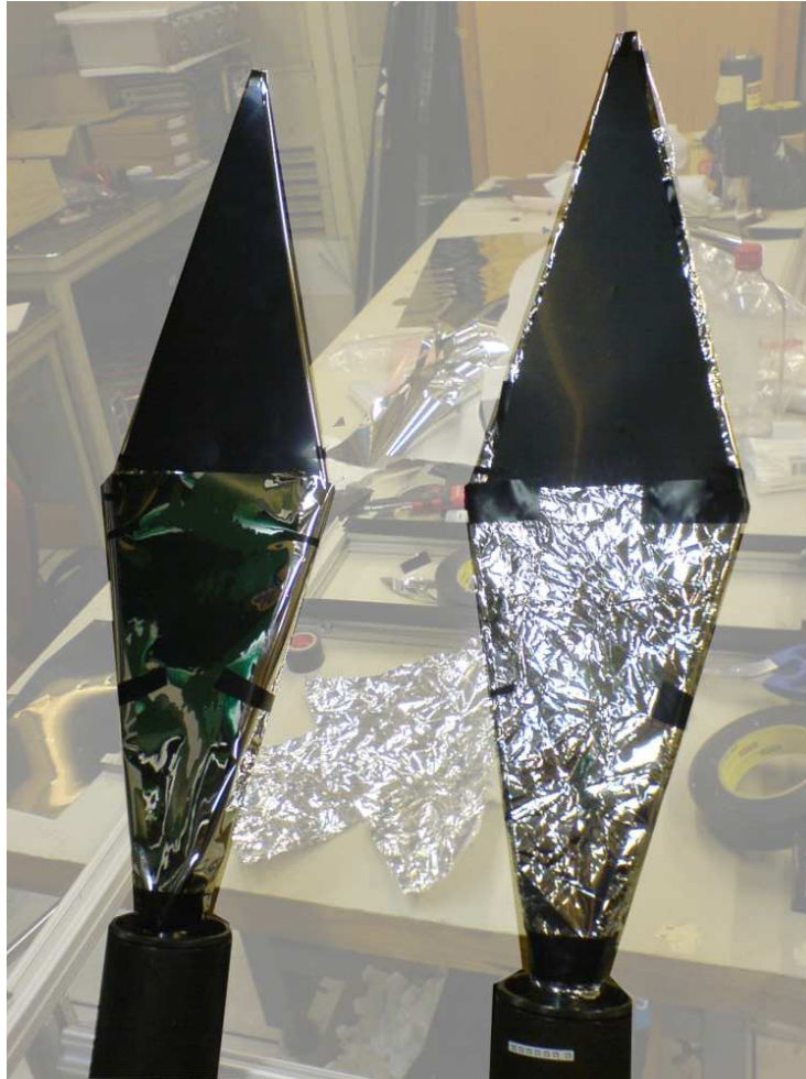
Abbildung 9.3: Verpackung der Segmente. Links im Bild ist Detektor 1 mit der glatten Verpackung zu sehen, rechts Detektor 2 mit der geknitterten Verpackung. Es ist bereits ein Teil der lichtdichten zweiten Lage auf den Detektoren zu sehen.
