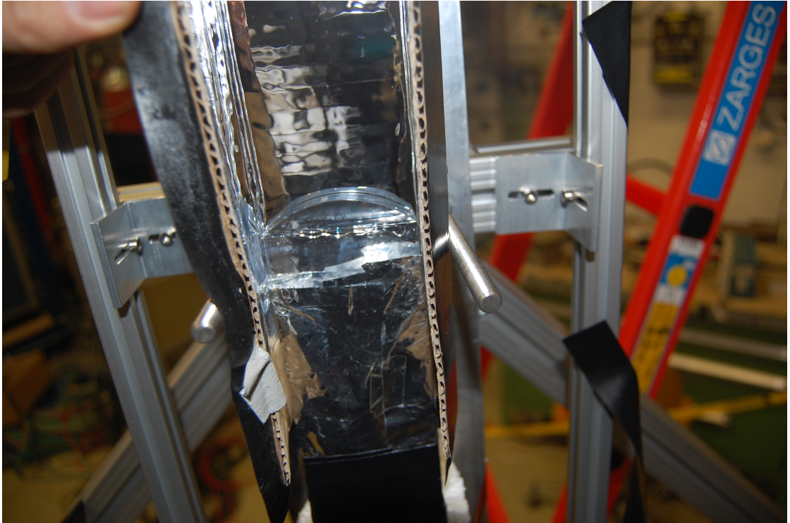
Abbildung A.2.: Unterer Teil des Luftlichtleiters mit aufgeklebten Linsen während der Messung am Mainzer Mikrotron
