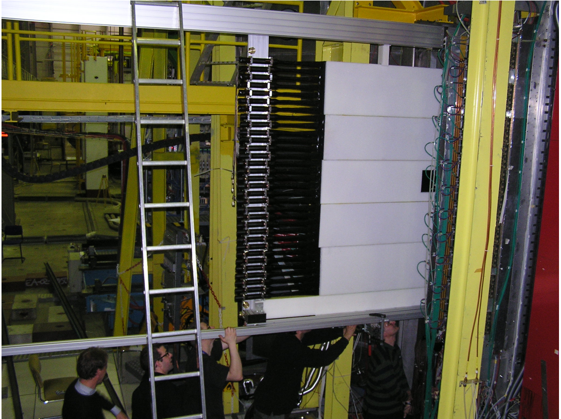
Abbildung A.4.: Installation des Hodoskopes zwischen den umgebenden Detektoren
