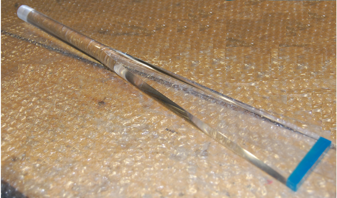
Abbildung 5.10.: Bei H1 verwendeter Lichtleiter. Das vordere Ende wurde für die Klebung an den Szintillator mit Klebeband geschützt.
