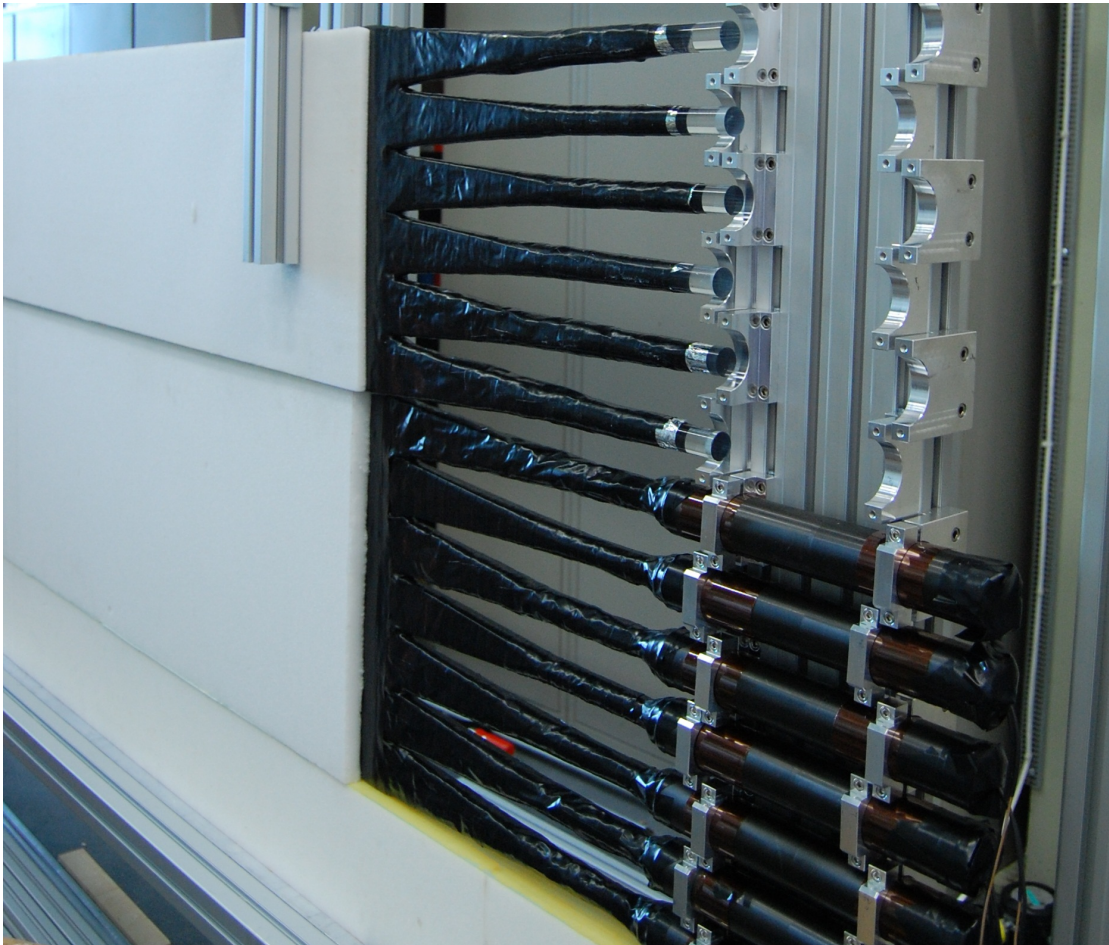
Abbildung 5.4.: Die beiden unteren Pakete, teilweise bestückt mit Weicheisenabschirmungen und Photomultipliern. Gut zu erkennen ist die zusätzliche Verpackung in Rohacell
