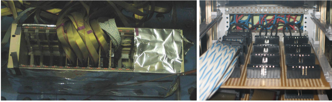
Abbildung 5.4: Die Stromversorgung der Summationskarten erfolgt über die links dargestellte Box. In diese können Karten mit 12 Steckern geschoben werden, wie im rechten Bild zu sehen ist.
