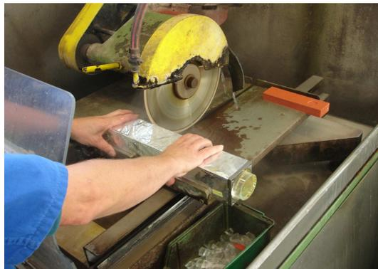
**Abbildung 7.1:** Zuschnitt der beiden Gläser TF1 und SF57 bei der Firma SCHOTT AG.
