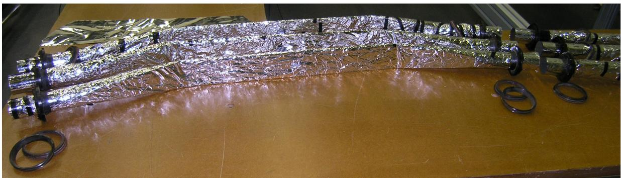
**Abbildung 8.3:** Drei Elemente des inneren Rings eingepackt in aluminisiertes Mylar
