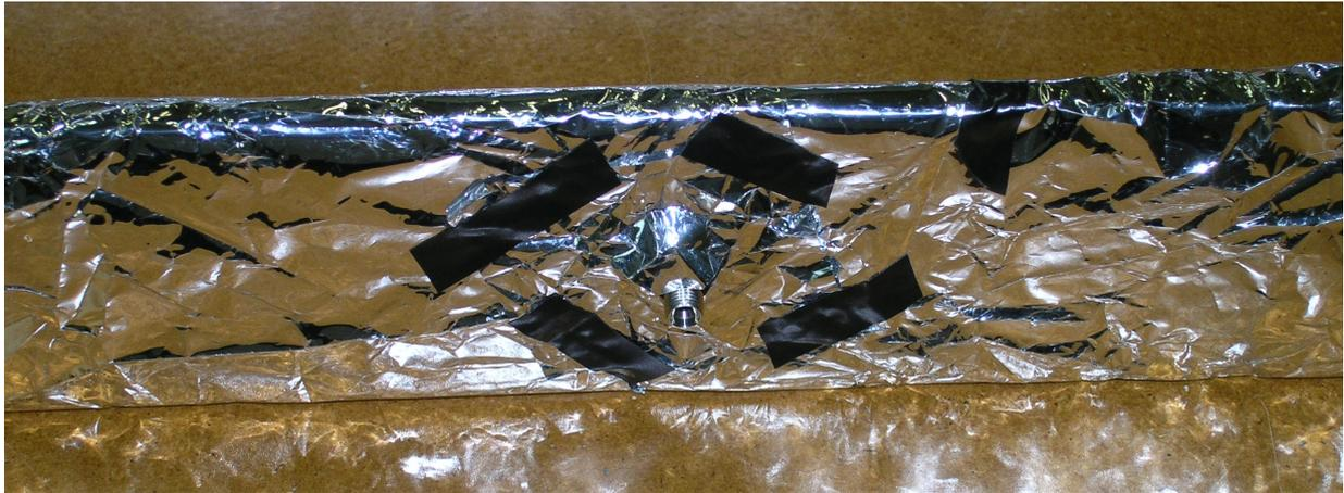
**Abbildung 8.5:** Steckverbinder in der Mitte eines Szintillators des inneren Rings zur Einkopplung des Kalibrationslaserlichts
