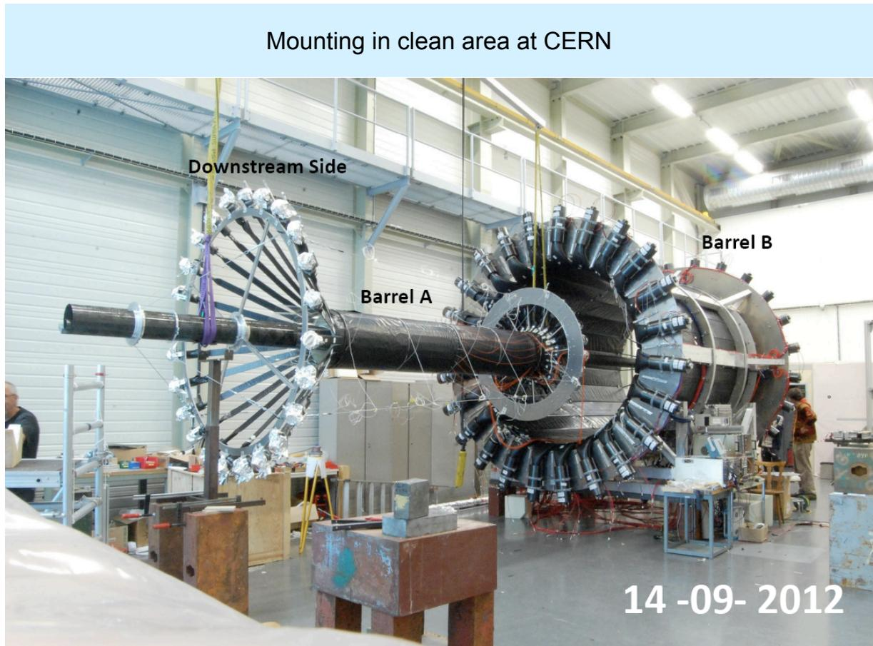
Abbildung 1: Einbau des inneren Rings von CAMERA in den äußeren Ring
