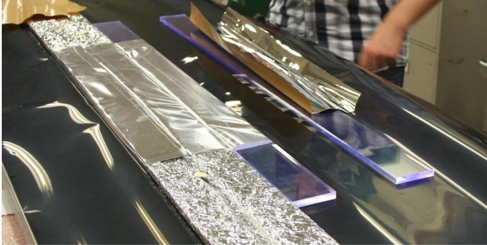
**Abb. 2.9.:** Die ersten drei Luftlichtleiter sind auf die schwarze Folie geklebt. In die ersten beiden wurden auch schon die Szintillatoren eingesteckt. Einer der Hilfsszintillatoren ist im dritten Lichtleiter, der andere liegt bereit um in die Daylightfolie eingepackt zu werden
