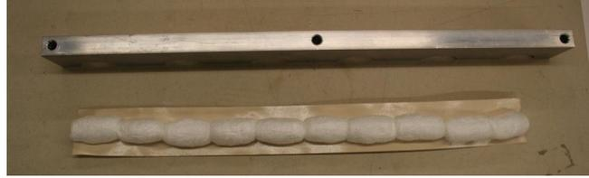
**Abb. A.2.:** Aluminiumrechteckprofil und ein mit Verpackungsflocken bestücktes Klebeband, das zur Polsterung aufgeklebt wird
