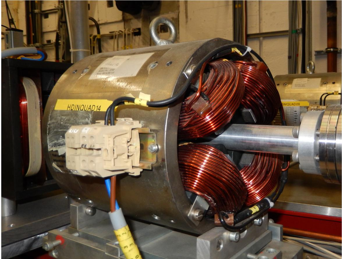
Polschuhlänge: 18 cm; Durchmesser: 20 cm; Gradient<sup>11</sup>: 7 T/m; Appertur<sup>11</sup>: 40 mm
