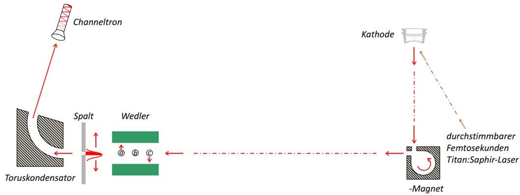
Abbildung 3.3: Aufbau zur Messung der Strahlbreite.
