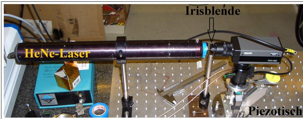
Abbildung 3.6: Aufbau zur Ausmessung der horizontalen Piezotischbewegung. Am Laser ist mit Klebeband ein Abschwächer befestigt.
