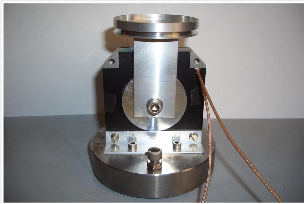
Abbildung 5.5: Piezotisch, der spannungsgesteuerte Bewegungen in horizontaler Richtung (vom Betrachter aus nach links und rechts), bzw. in vertikaler Richtung ausführen kann.
