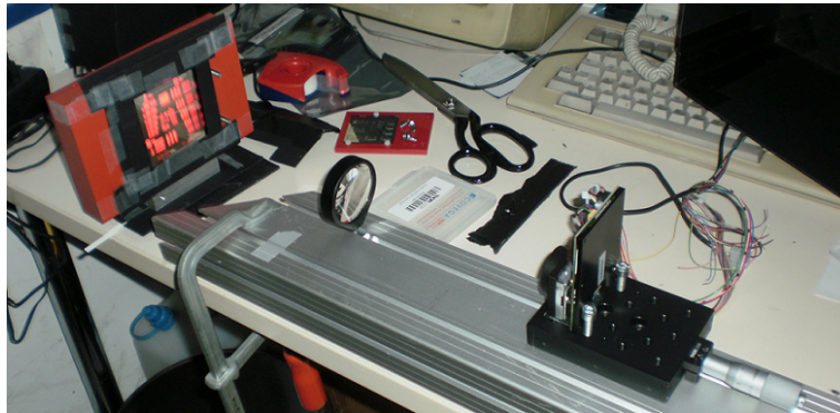
(a) Aufbau zur Bestimmung der Tiefenschärfe. Der Abstand zwischen Linse und Kamera wird variiert.
