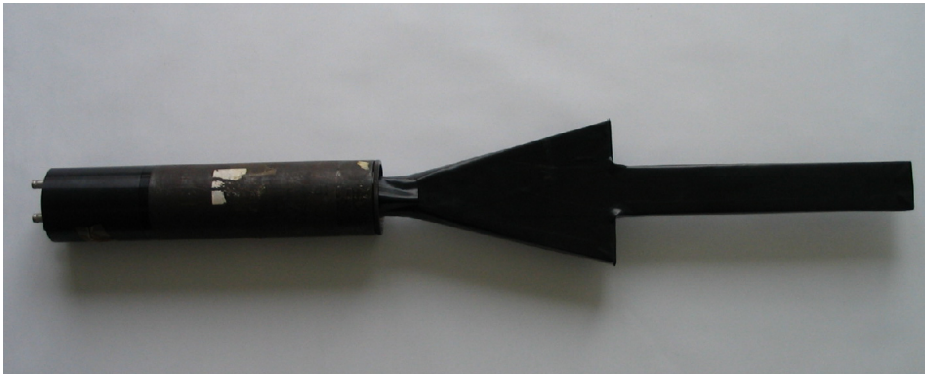
Abbildung 33: Photographie des Szintillator-Prototypdetektors. Das linke zylindrische Gehäuse beherbergt den Photomultiplier samt Spannungsteiler. Der quaderförmige Szintillator auf der rechten Seite des Bildes ist über einen Lichtleiter (dreieckiges Gebilde) an dem Photomultiplier angekoppelt.
