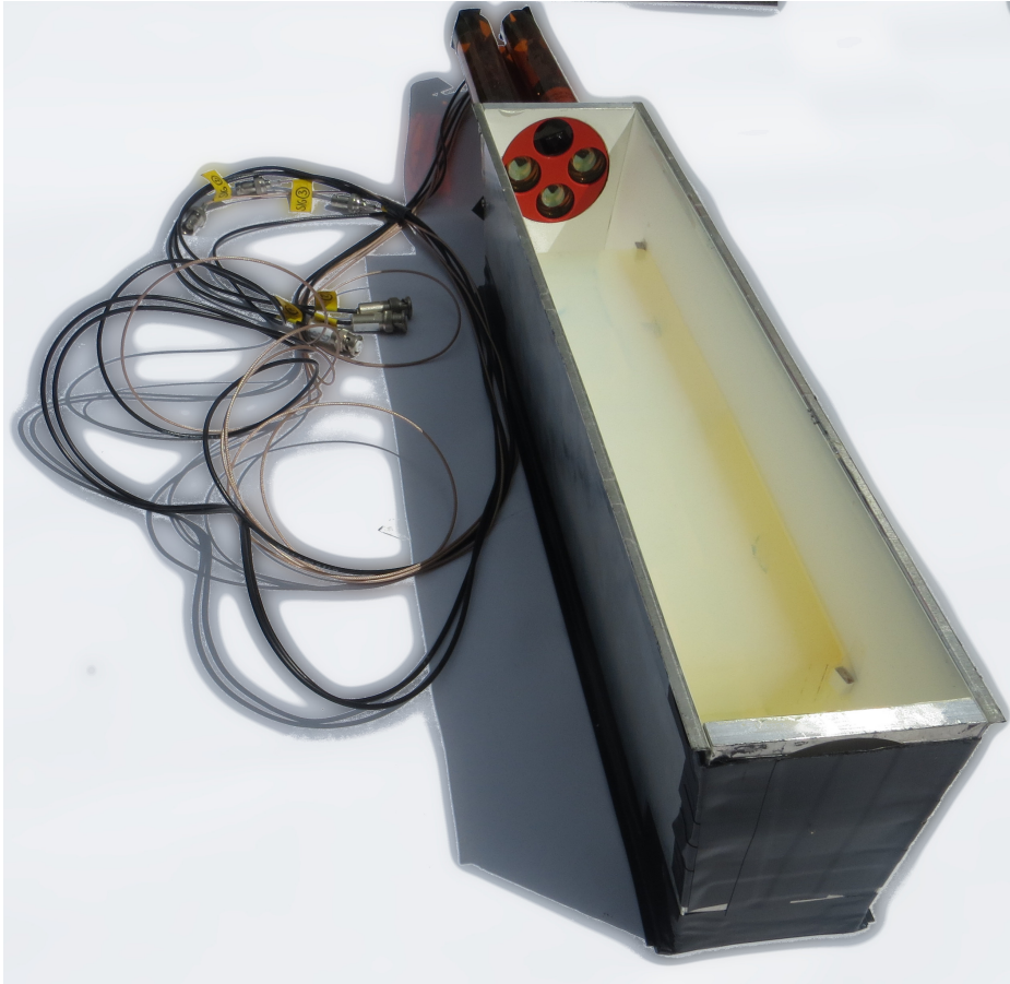
Abbildung 31: Photographie des Aerogel-Tscherenkovzählers. Die obere Abdeckung des Gehäuses ist entfernt. Im Inneren ist gelblich schimmernd bis auf etwa halbe Höhe des Gehäuses die Aerogelfüllung zu erahnen. Am oberen Rand des Bildes befinden sich die vier Photomultiplier, deren Eintrittsfenster ins Innere des Gehäuses zeigen und die über eine rote runde Adapterplatte aus Kunststoff fixiert sind.
