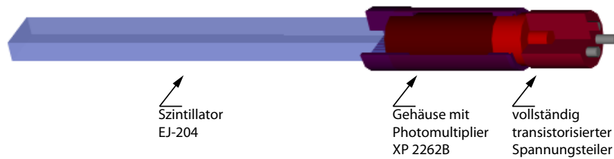
Abbildung 38: Zeichnung eines Einzelmoduls des Elektronentaggers. Der auf der linken Seite zu erkennende Plastiksintillator ist über einen Adapter aus PVC an den Photomultiplier gekoppelt. Dieser ist wiederum von einem Aluminiumgehäuse umgeben, das ebenfalls mit dem Adapter verbunden ist. An der Basis des Multipliers ist ein vollständig transistorisierter Spannungsteiler gesteckt. Das gezeigte Modul ist so ausgelegt, daß es zwei Detektorrahmen, insgesamt 14 \text{PbF}_2 -Kristalle, überdeckt.
