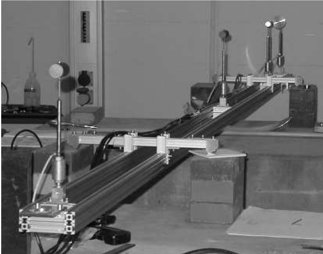
Abbildung 30: Der fahrbare hintere Teil des Polarimeters ('Trägergestell') vor dem Einbau mit den Bauteilen (von links nach rechts): 2. Aufstreuer, 3. Aufstreuer, SEM1, Magnet, Wandler (hier mit Justieraufsatz) und SEM2. Der Elektronenstrahl trifft von vorne links auf das Polarimeter. An den Querträgern befinden sich die Kugelrollen, auf denen das Gestell in das Strahlführungsrohr gefahren wird.
