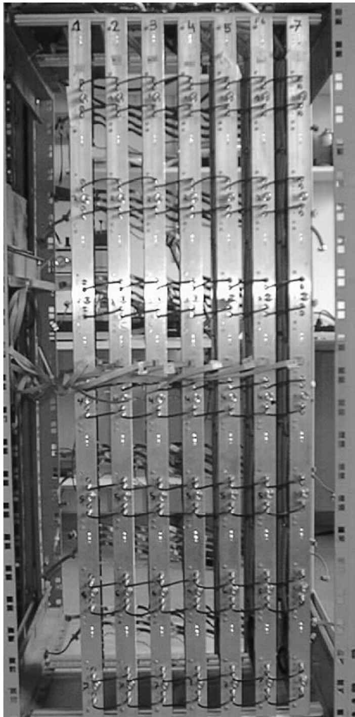
Abbildung D.2: Ansicht des Prototyp-Aufbaus mit 49 Kanälen. Man erkennt die Frontseiten von sieben Triggermodulen. Ebenfalls zu sehen ist die Verkabelung der Analogsignale zu den benachbarten Modulen.
