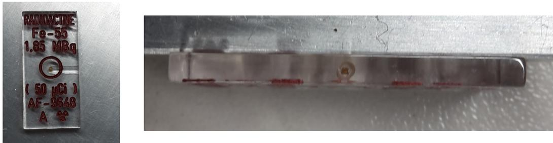
Abbildung 7: Bild der Eisenprobe im Plastik
